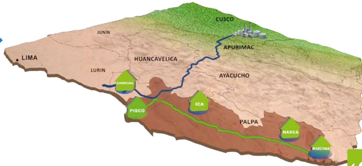
El gasoducto está compuesto por redes troncales (236,9 km) y ramales (78,8 km), a diciembre de 2013. La red de troncales se inicia en Humay, lugar donde nuestra red recibe el gas proveniente del yacimiento de Camisea. La conexión entre las troncales y ramales se realiza a través de válvulas de derivación, que permiten el flujo del gas hacia los ramales que se dirigen a cada uno de los centros urbanos.
